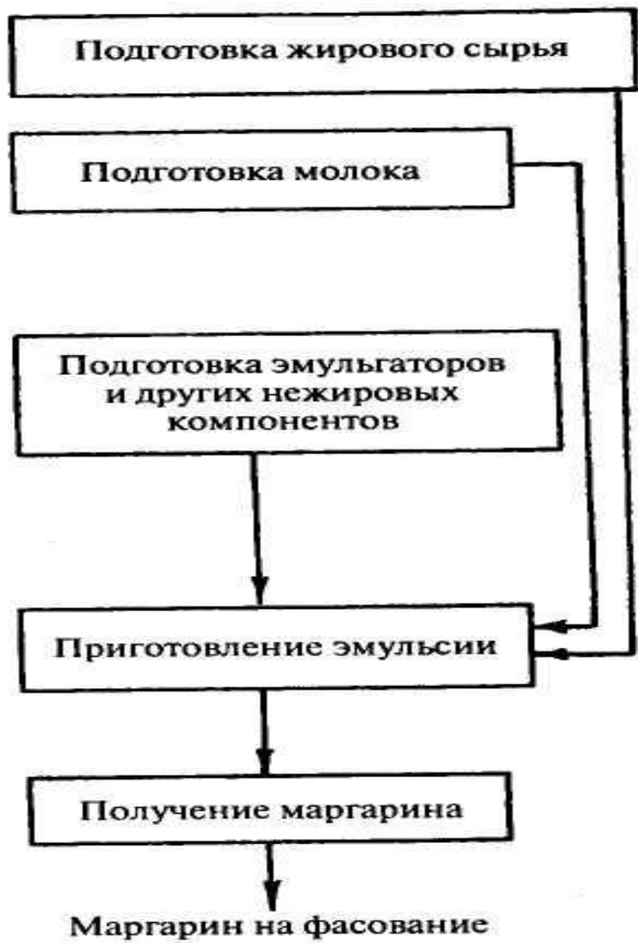
Рис. 25.33. Принципиальная технологическая схема получения маргарина
