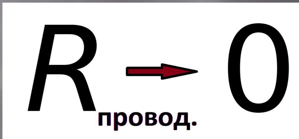
При коротком замыкании резко возрастает сила тока, протекающего в цепи, что приводит к значительному тепловыделению, и, как следствие, термическому повреждению устройства или электрических проводов, вплоть до возникновения пожара или электрической травмы.
