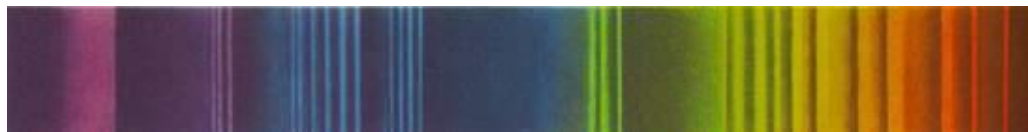
Спектр испускания паров молекулы иода.
