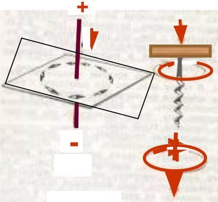
**Прямой проводник:** если поступательное движение буравчика совпадает с направлением тока, то вращательное движение его ручки совпадает с направлением магнитных линий магнитного поля тока.
