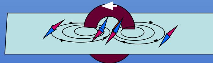
Направление магнитных линий связано с направлением тока в проводнике
