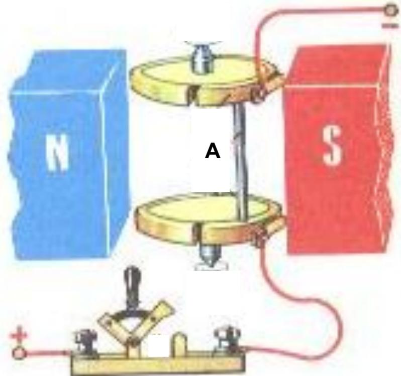
Между полюсами магнита находится  $\Pi$ -образный проводник. К концам проводника прижаты контакты – щётки **A** и **B**. Опишите, что будет происходить с проводником.
