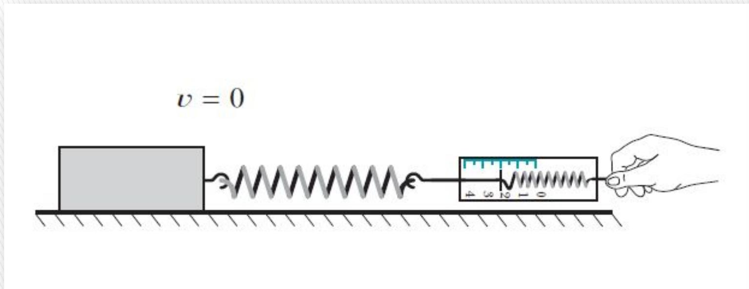
На горизонтальной поверхности стола лежит брусок. Для того чтобы сдвинуть брусок с места, необходимо подействовать на него с силой, параллельной поверхности стола.
