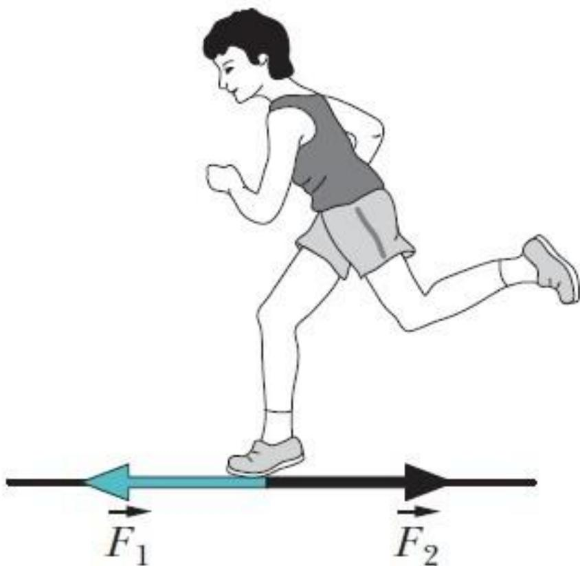
Во время бега сила трения покоя  $F_1$ , действующая на подошву обуви, сообщает спортсмену ускорение. Подошва не скользит назад. Трение между подошвой и дорогой – это трение покоя. Сила  $F_2$ , равная по модулю силе трения покоя  $F_1$ , противоположна направлена и приложена к опоре.
