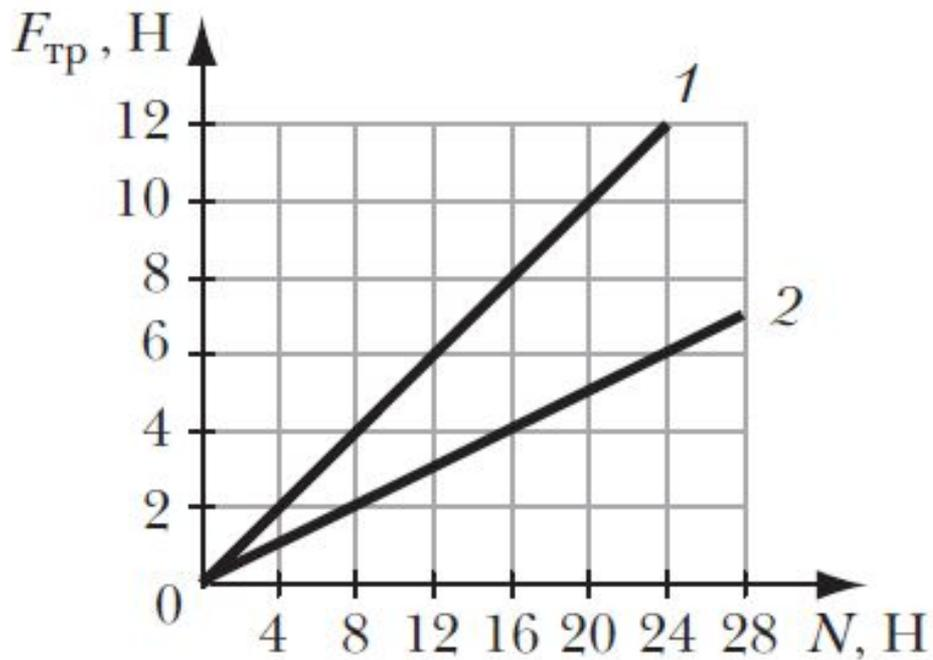
На рисунке изображены графики 1 и 2 зависимости модуля силы трения скольжения от модуля силы реакции опоры.
