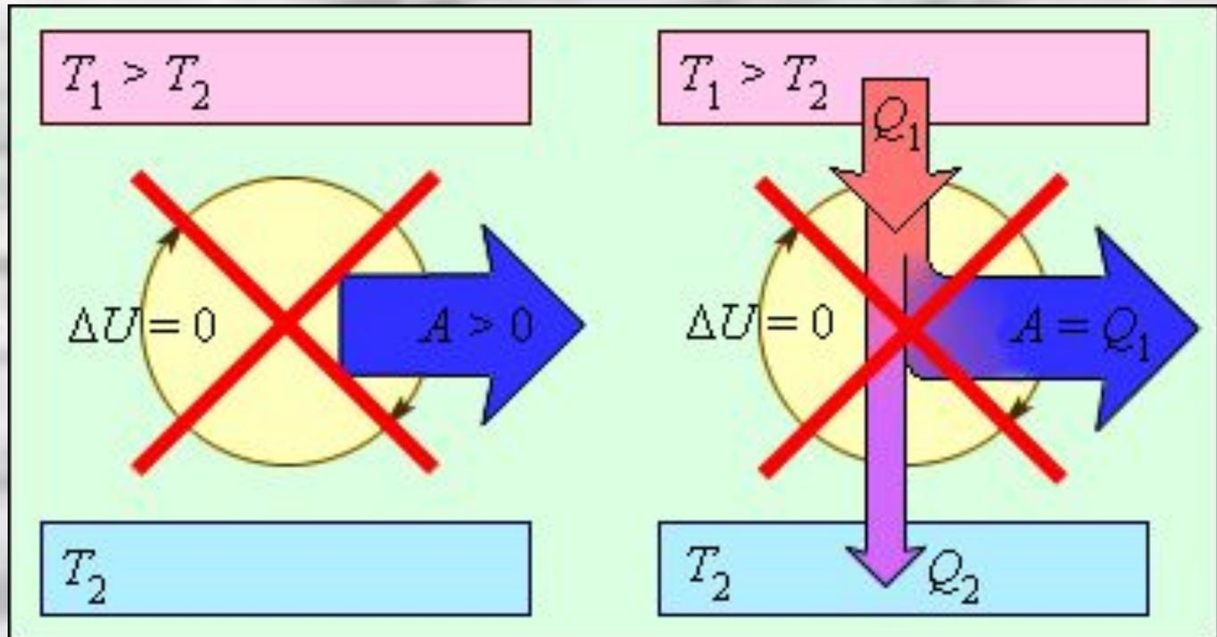
Циклически работающие тепловые машины, запрещаемые первым законом термодинамики: 1 – вечный двигатель 1 рода, совершающий работу без потребления энергии извне; 2 – тепловая машина с коэффициентом полезного действия  $\eta > 1$
