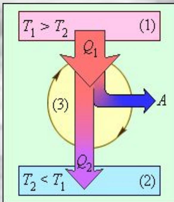
Энергетическая схема тепловой машины: 1 – нагреватель; 2 – холодильник; 3 – рабочее тело, совершающее круговой процесс.
