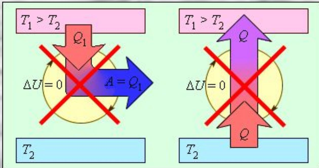
Процессы, не противоречащие первому закону термодинамики, но запрещаемые вторым законом: 1 – вечный двигатель второго рода; 2 – самопроизвольный переход тепла от холодного тела к более теплomu (идеальная холодильная машина)
