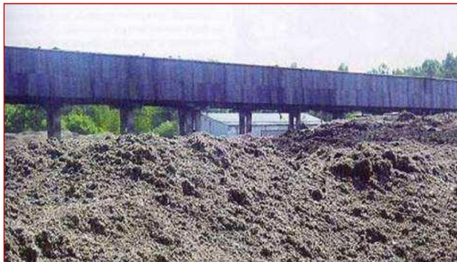
За 48 часов из отходов в биобарабане образуется **компост** – влажная рассыпчатая темно-серая масса. Очищенный от примесей (полиэтиленовые пленки и др.) компост является хорошим удобрением, содержащим минеральные и органические вещества.
