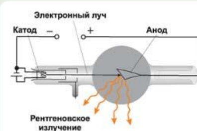
Устройство рентгеновской трубки
