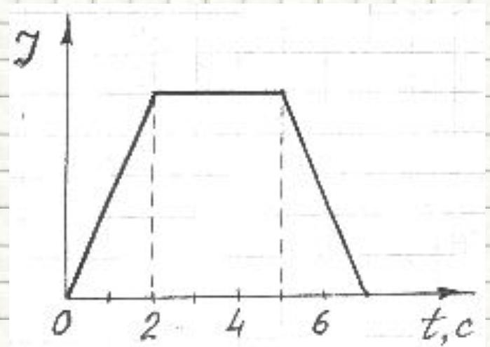
**(ЕГЭ 2002 г., Демо) А19.** В металлическое кольцо в течение первых двух секунд вдвигают магнит, в течение следующих двух секунд магнит оставляют неподвижным внутри кольца, в течение последующих двух секунд его вынимают из кольца. В какие промежутки времени в катушке течет ток?
