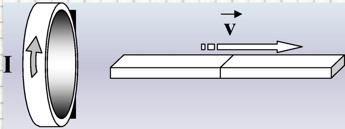
**A19.** На рисунке приведена демонстрация опыта по проверке правила Ленца. Опыт проводится со сплошным кольцом, а не разрезанным,
