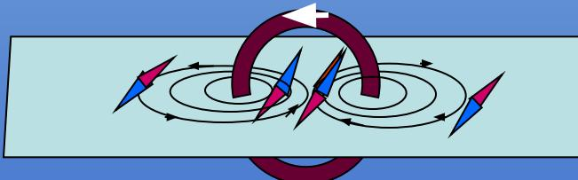
Направление магнитных линий связано с направлением тока в проводнике
