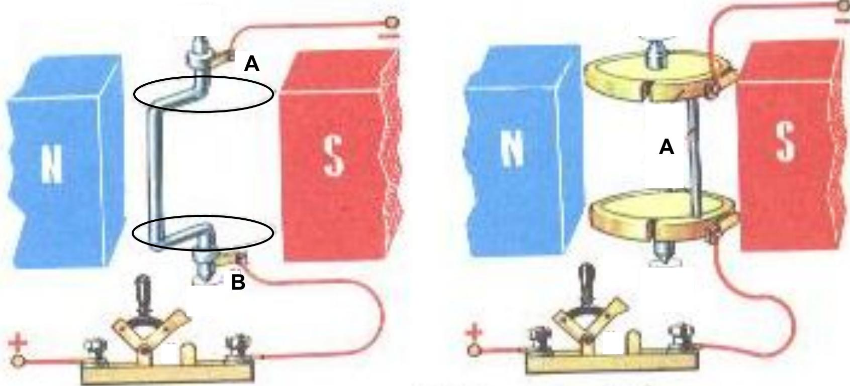
Между полюсами магнита находится **Л**-образный проводник. К концам проводника прижаты контакты – щётки **A** и **B**. Опишите, что будет происходить с проводником.
