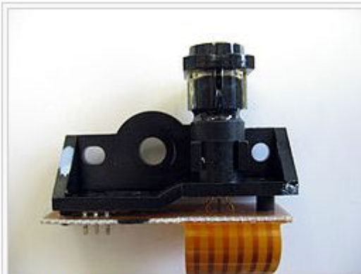
Полупроводниковый лазер, применяемый в узле генерации изображения принтера Hewlett-Packard
