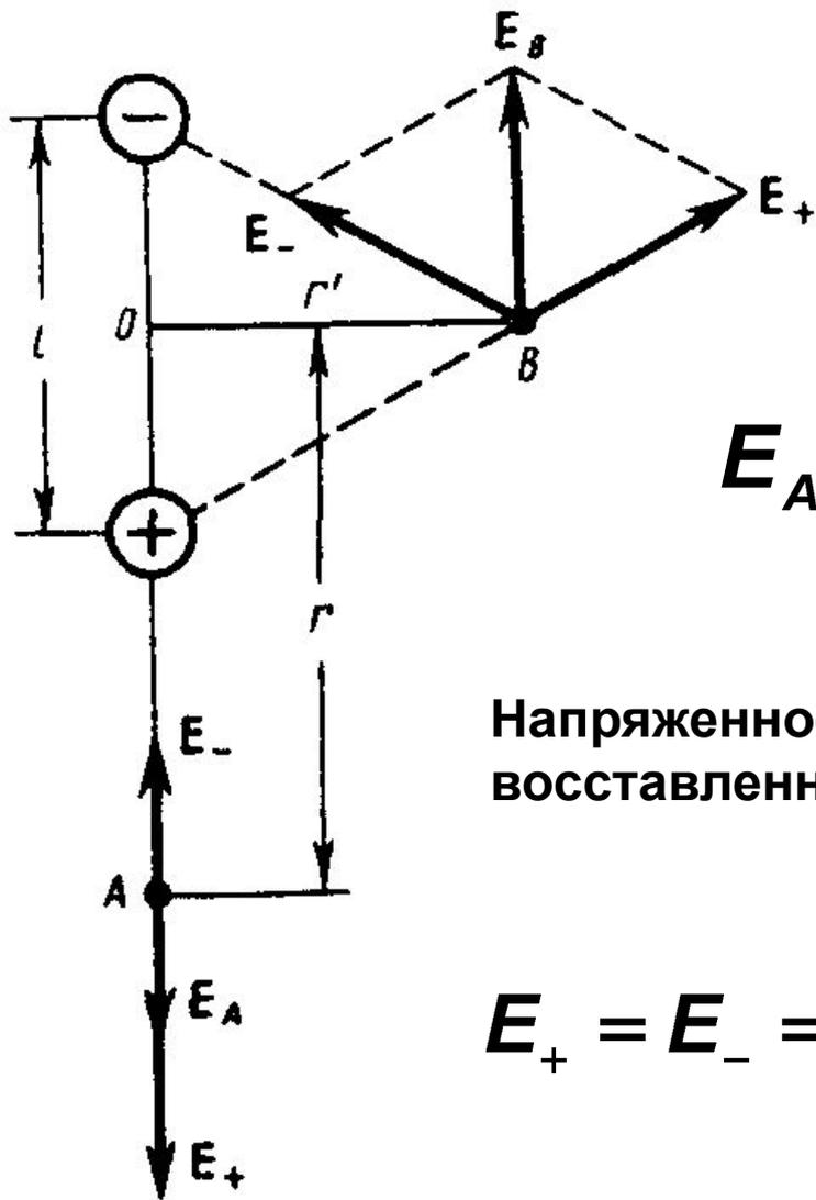
Напряженность поля на продолжении оси диполя в точке  $A$ .
