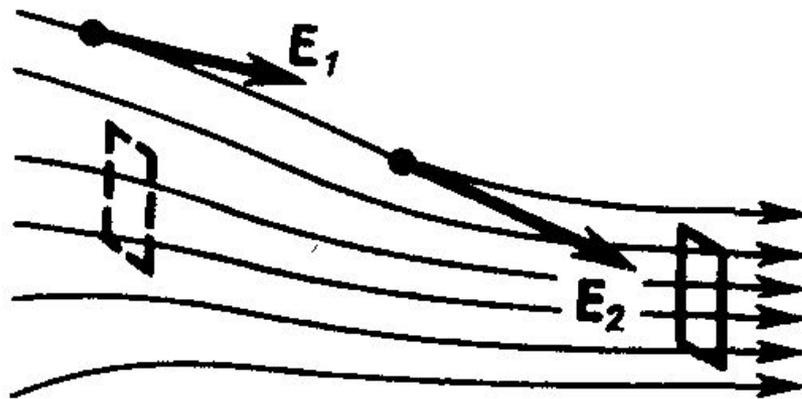
Число линий напряженности, пронизывающих единицу площади поверхности, перпендикулярную линиям напряженности, должно быть равно модулю вектора  $E$ .
