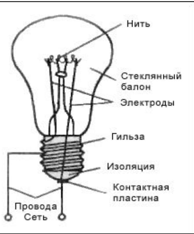
Принцип действия ламп накаливания это преобразование электрической энергии в световую энергию. Вольфрамовая нить разогревается до температуры 2600 – 3000 С, но нить не плавится так как температура плавления вольфрама равна 3200 – 3400 С. И это явление позволяет нам использовать вольфрам в качестве нити накаливания.
