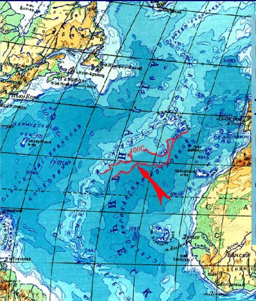
Вместо горизонталей на участках карт, изображающих водную поверхность, используют особые линии. Эти линии, соединяющие точки с одинаковой глубиной, называются изобатами. В отличие от коричневых горизонталей, изобаты окрашивают в синий цвет, а для послыной окраски используют различные оттенки синего цвета.
