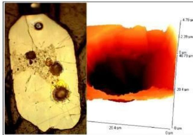
Микрозерно циркона после лазерной абляции (данные ACM)
