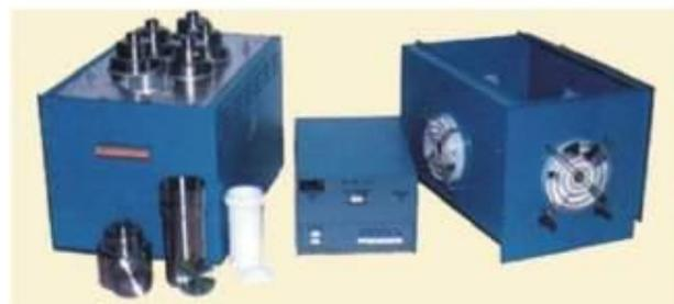
**Модуль автоклавной пробоподготовки МКП-05**
