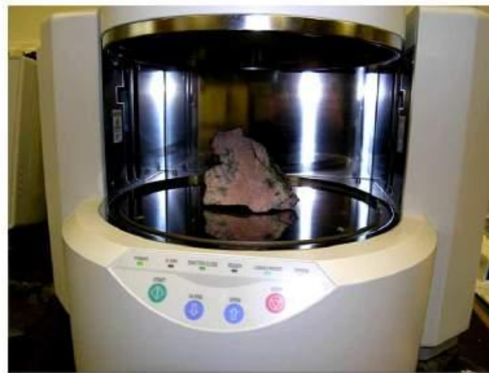
Камера спектрометра EDX-900HS с образцом
