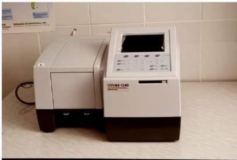
Оптический спектрометр UV1240
