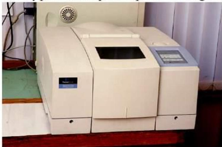
ИК-Фурье спектрометр Spectrum
