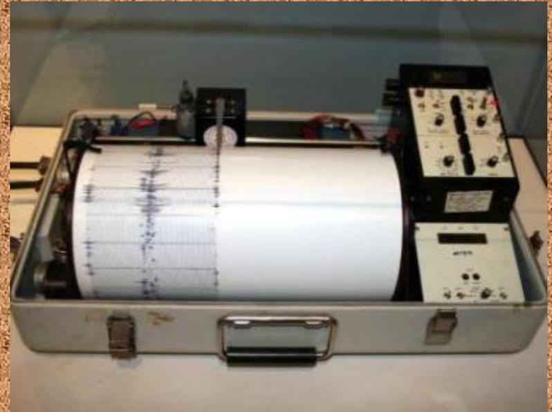
**Сейсмограф** – это чувствительный прибор, который улавливает и регистрирует подземные толчки, отмечает их силу, направление и продолжительность.
