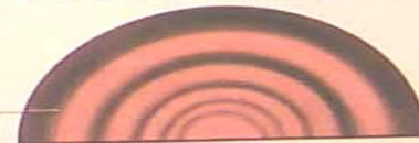
КРИВИЗНА ЛИНЗЫ МЕНЬШЕ КРИВИЗНЫ ПРОБНОГО СТЕКЛА
