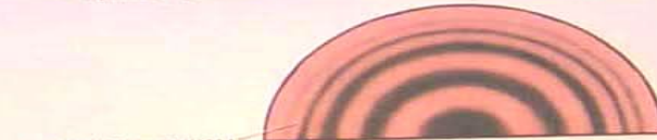
КРИВИЗНА ЛИНЗЫ БОЛЬШЕ КРИВИЗНЫ ПРОБНОГО СТЕКЛА
