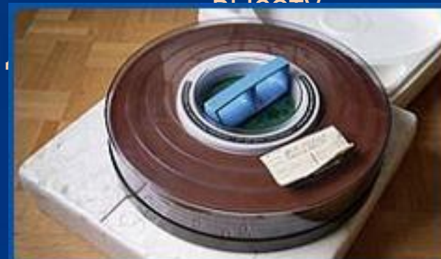
IBM 1316: накопитель со сменными носителями
