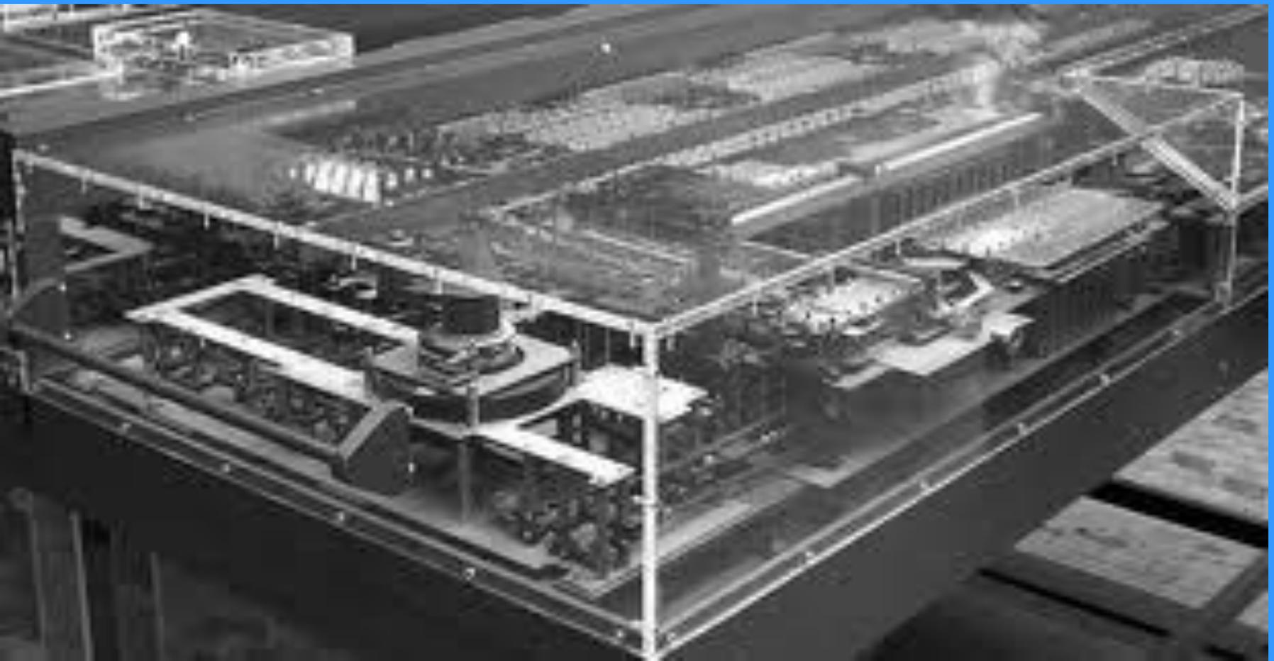
В 1938 году Цьюз завершил работу над прототипом электромеханического двоичного программируемого калькулятора V1 (после войны он был переименован в Z1). Эта машина могла работать с плавающей точкой и отрицательными числами.
