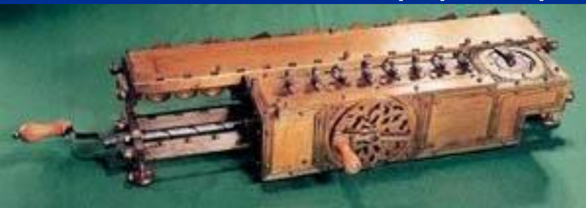
Механический арифмометр Лейбница (1673г.)
