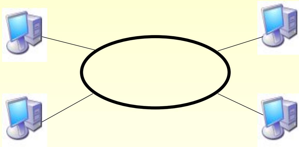
Эта топология представляет собой последовательное соединение компьютеров, когда последний соединён с первым.
