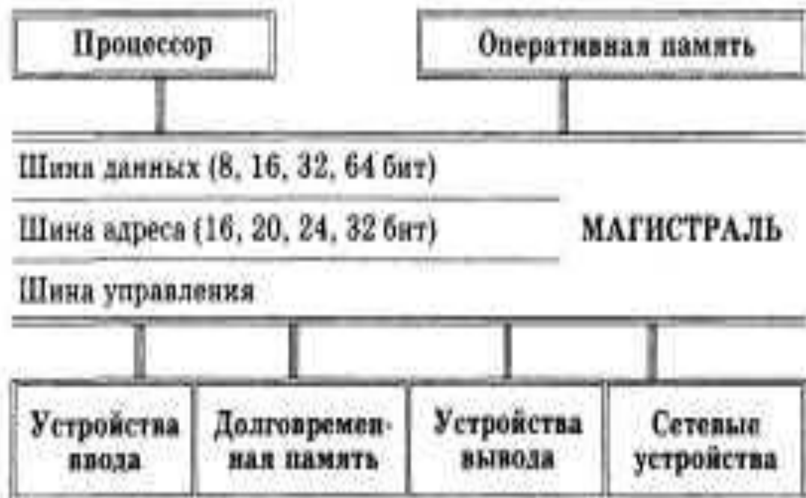
Рис. 7. Магистрально-модульное устройство компьютера
