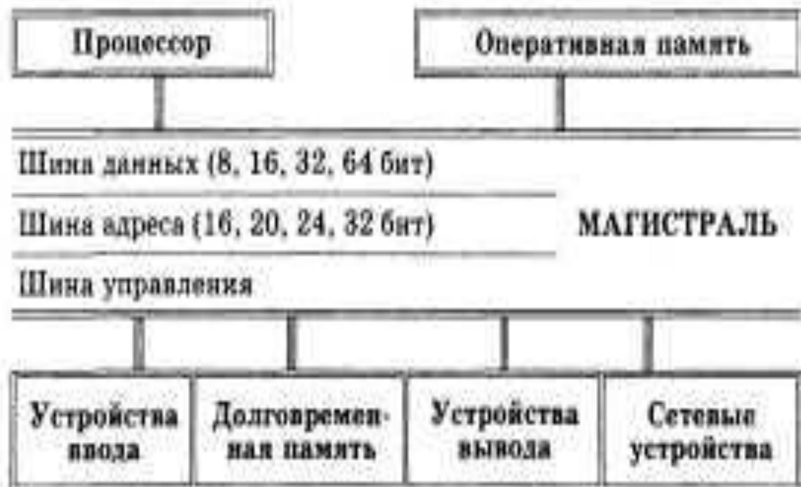
*Рис. 7. Магистрально-модульное устройство компьютера*
