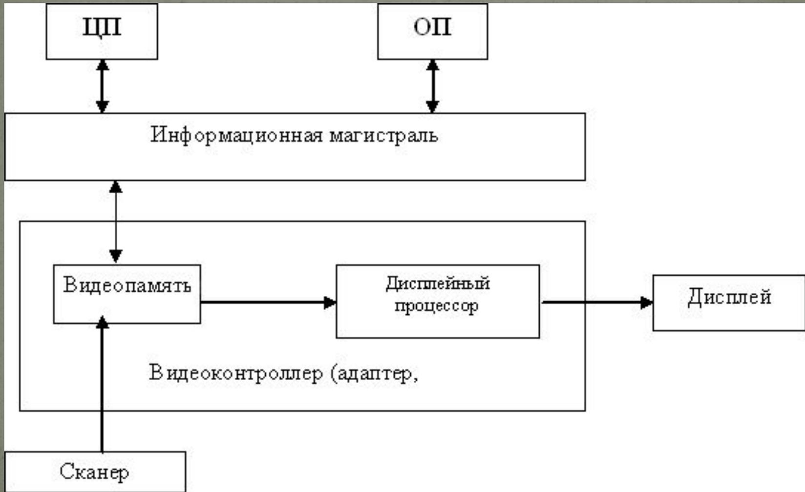
Видеоадаптер — это электронная плата, которая обрабатывает видеоданные (текст и графику) и управляет работой дисплея. Содержит видеопамять, регистры ввода вывода и модуль BIOS. Посылает в дисплей сигналы управления яркостью лучей и сигналы развертки изображения.
