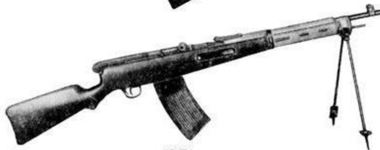
6.5-мм автомат системы В.Г.Федорова обр.1916 г., со складными сошками
