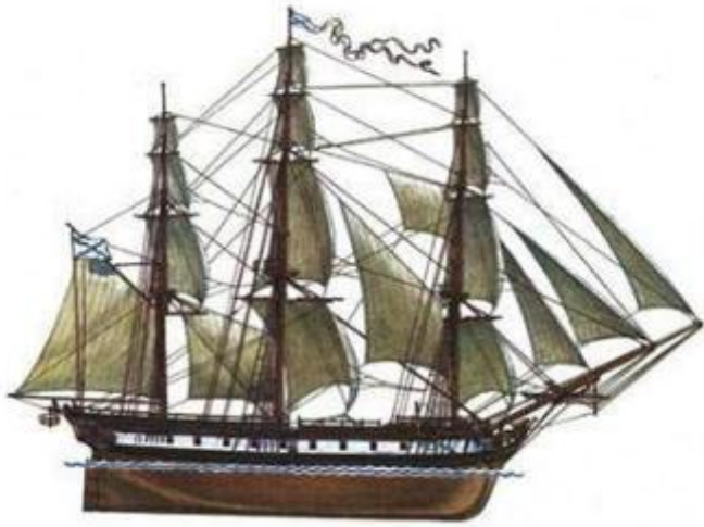
«Восток» (построен в 1818 году в Петербурге, водоизмещение - 900 тонн, вооружение-28 орудий, экипаж-117 человек)
