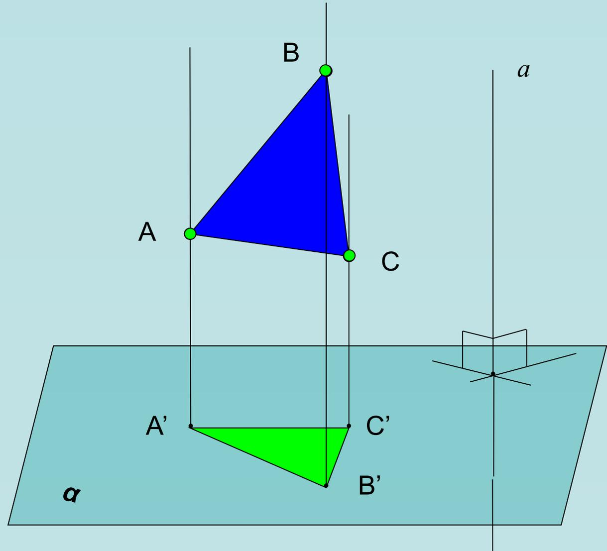
**Примечание 4.** Если плоскость проекций и плоскость, в которой лежит данная фигура параллельны ( $\alpha \parallel (ABC)$ ), то получающееся при этом изображение...
