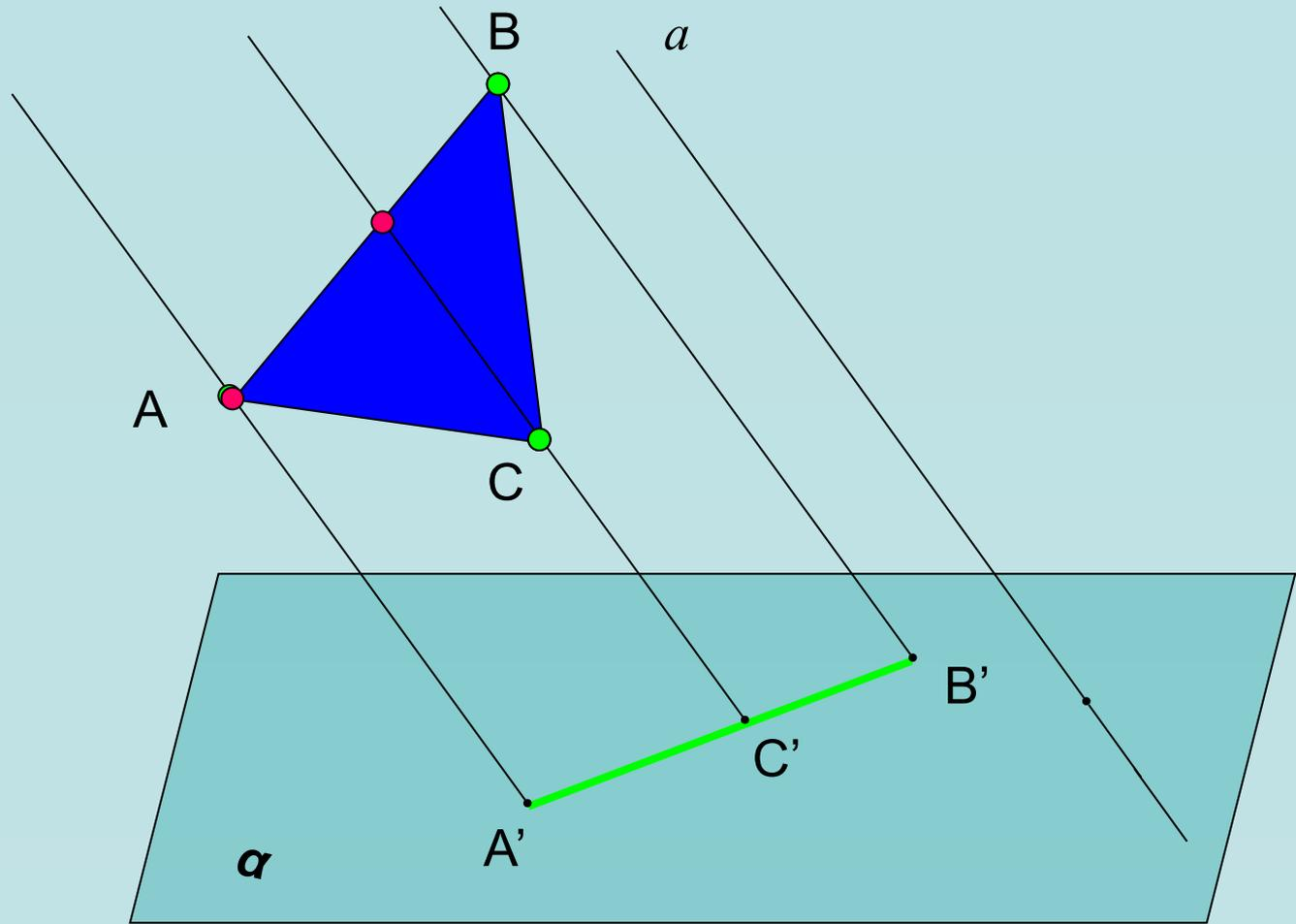
**Примечание 3.** Если направление параллельного проектирования перпендикулярно плоскости проекций, то такое параллельное проектирование называется **ортогональным (прямоугольным) проектированием**.
