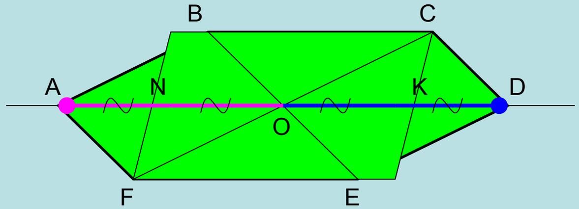
Разобьем правильный шестиугольник на три части: прямоугольник FBCE и два равнобедренных треугольника  $\triangle FAB$  и  $\triangle CDE$ . Построим вначале изображение прямоугольника FBCE – произвольный параллелограмм FBCE. Осталось найти местоположение двух оставшихся вершин – точек A и D.
