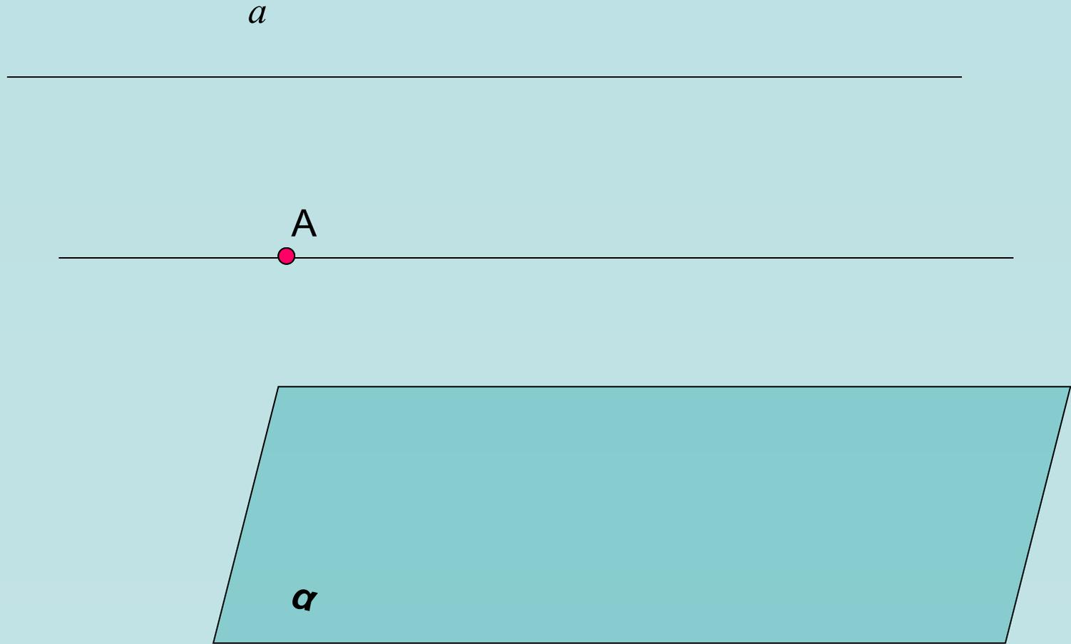
**Примечание 2.** При параллельном проектировании плоских фигур не выбирают направление параллельного проектирования параллельно плоскости, которой принадлежит эта плоская фигура, т.к. получающаяся при этом проекция не отражает свойства данной плоской фигуры.
