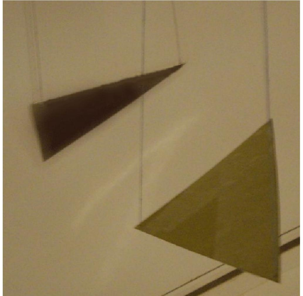
3. Если плоскость треугольника **перпендикулярна** плоскости проекций, то на ней он изображается **в виде отрезка**
