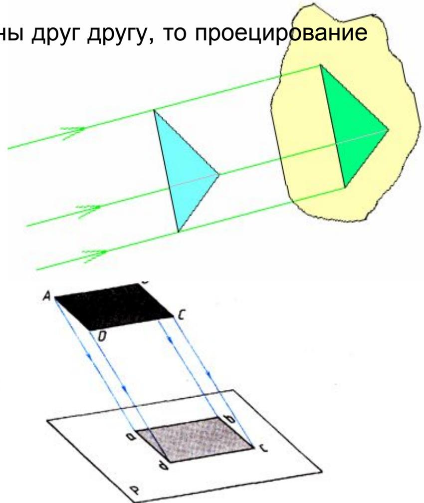
Рис. 80. Параллельное косоугольное проецирование
