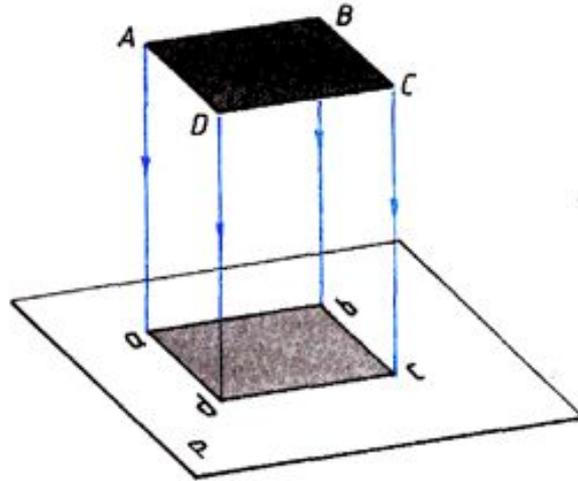
Рис. 79. Параллельное прямоугольное (ортогональное) проецирование
