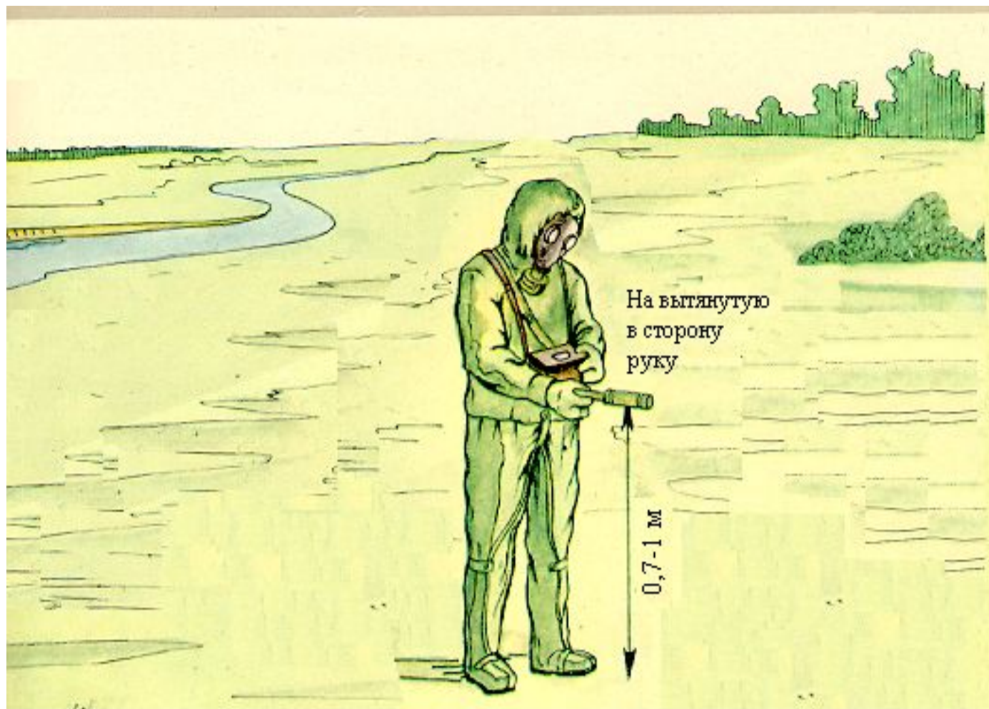
Измерение уровня радиации на местности.
