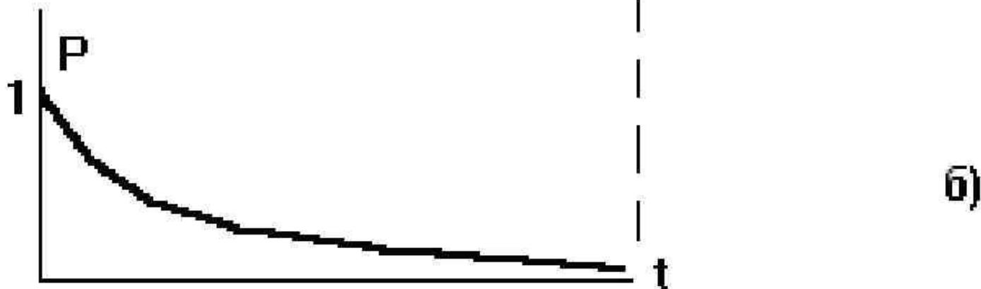
Зависимость интенсивности отказов от времени эксплуатации (а) и распределение вероятности безотказной работы оборудования (б)
