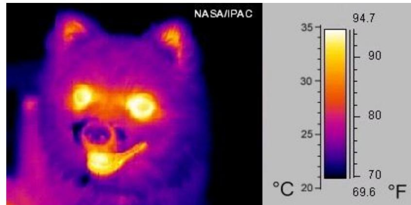
**Тепловизор** – устройство для наблюдения за распределением температуры исследуемой поверхности
