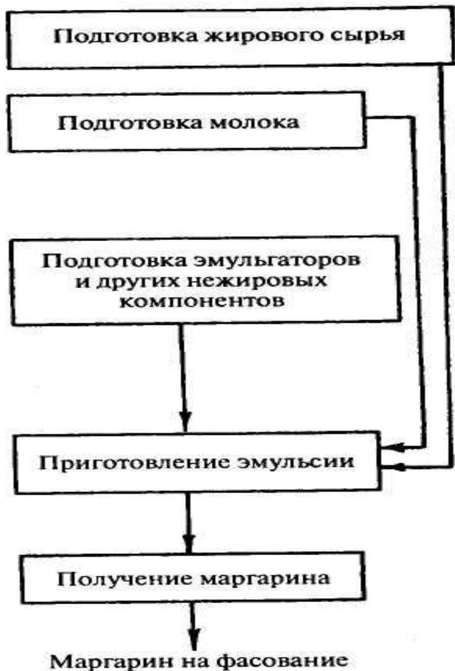
Рис. 25.33. Принципиальная технологическая схема получения маргарина
