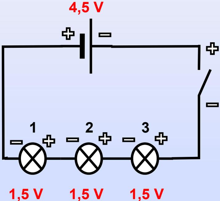
При последовательном соединении лампочки следуют друг за другом, зависят друг от друга и делят напряжение поровну между собой.
