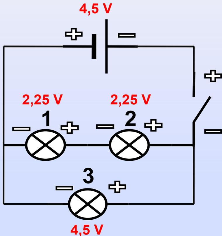
При смешанном соединении 1 и 2 лампочки делят напряжение поровну ( по  $2,25\text{ V}$  ), а 3 лампочка потребляет всё напряжение ( $4,5\text{ V}$ ), которое подаётся на неё.
