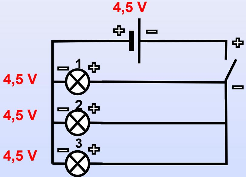
При параллельном соединении лампочки не зависят друг от друга и потребляют всё напряжение, которое подают на них.
