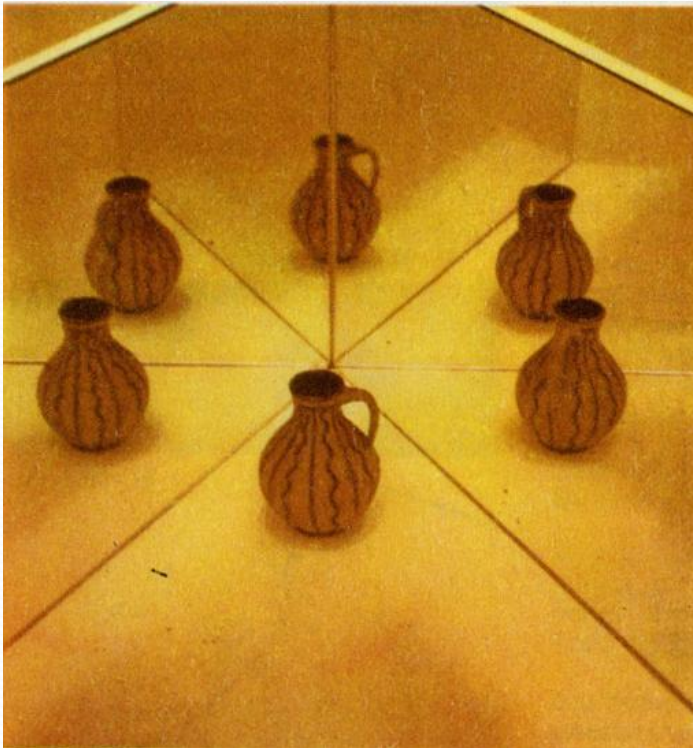
Угол между зеркалами 60^\circ , видим 5 изображений кувшина
