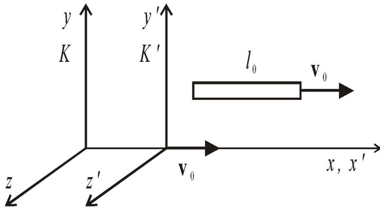
Стержень длины  $l'_0 = x'_2 - x'_1$  неподвижный относительно “штриховой” системы отсчета  $K'$ , движется вдоль оси  $X$  со скоростью  $v_0$
