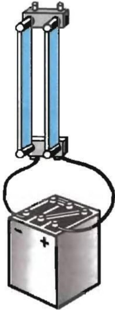
Возьмём два гибких проводника, укрепим их вертикально, а затем присоединим нижними концами к полюсам источника тока.
