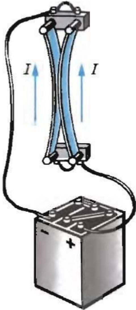
Но если другие концы проводников замкнуть проволокой так, чтобы в проводниках возникли токи **противоположного направления**, то проводники начнут **отталкиваться** друг от друга.
