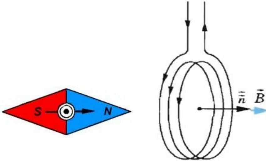
За **направление** вектора магнитной индукции принимается направление от **южного полюса к северному** магнитной стрелки, свободно устанавливающейся в магнитном поле. Это направление совпадает с направлением положительной нормали к замкнутому контуру с током.
