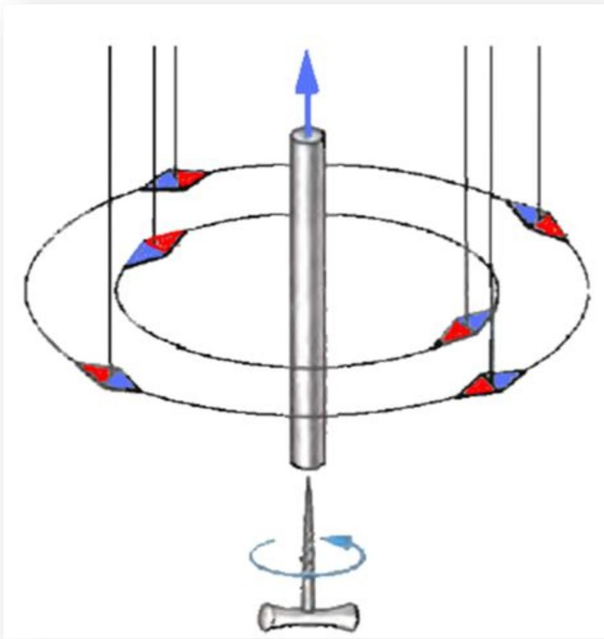
Для магнитного поля прямолинейного проводника с током линии магнитной индукции – concentric circles, lying in the plane, perpendicular to this conductor with current.
