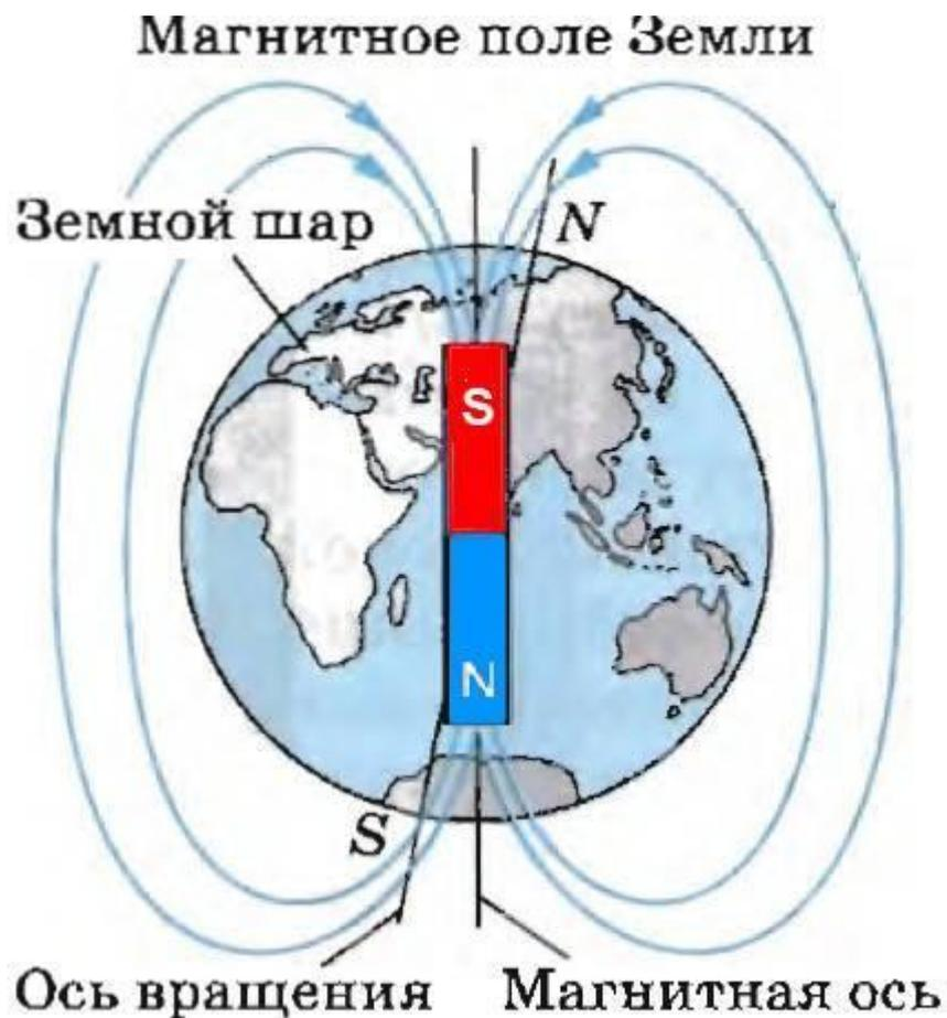
Линии магнитной индукции поля Земли подобны линиям магнитной индукции поля соленоида. Магнитный северный полюс N близок к южному географическому полюсу, а магнитный южный полюс S – к северному географическому полюсу.
