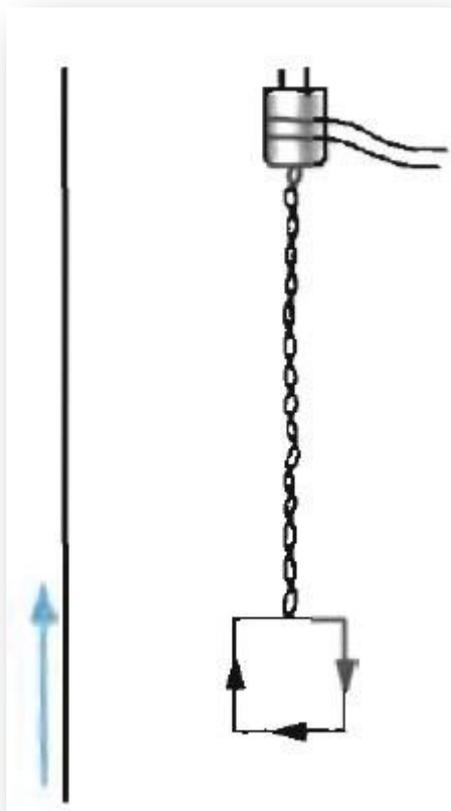
Подвесим на тонких гибких проводниках, сплетённых вместе, маленькую плоскую рамку, состоящую из нескольких витков проволоки. На расстоянии, значительно большем размеров рамки, вертикально расположим провод.
