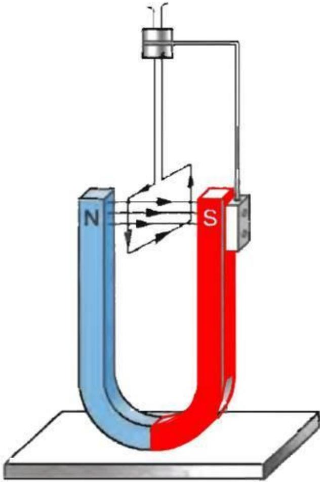
Если подвесить на гибких проводах рамку с током между полюсами магнита, то рамка будет поворачиваться до тех пор, пока плоскость её не установится перпендикулярно к линии, соединяющей полюсы магнита. Таким образом, однородное магнитное поле оказывает на рамку с током **ориентирующее действие**.
