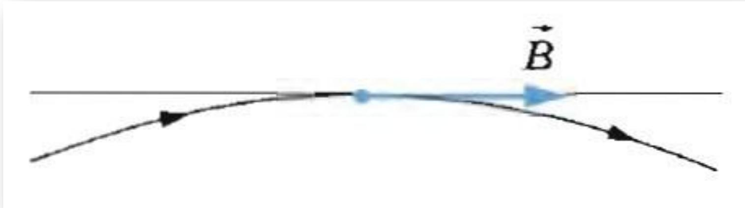
Наглядную картину магнитного поля можно получить, если построить так называемые **линии магнитной индукции**.
