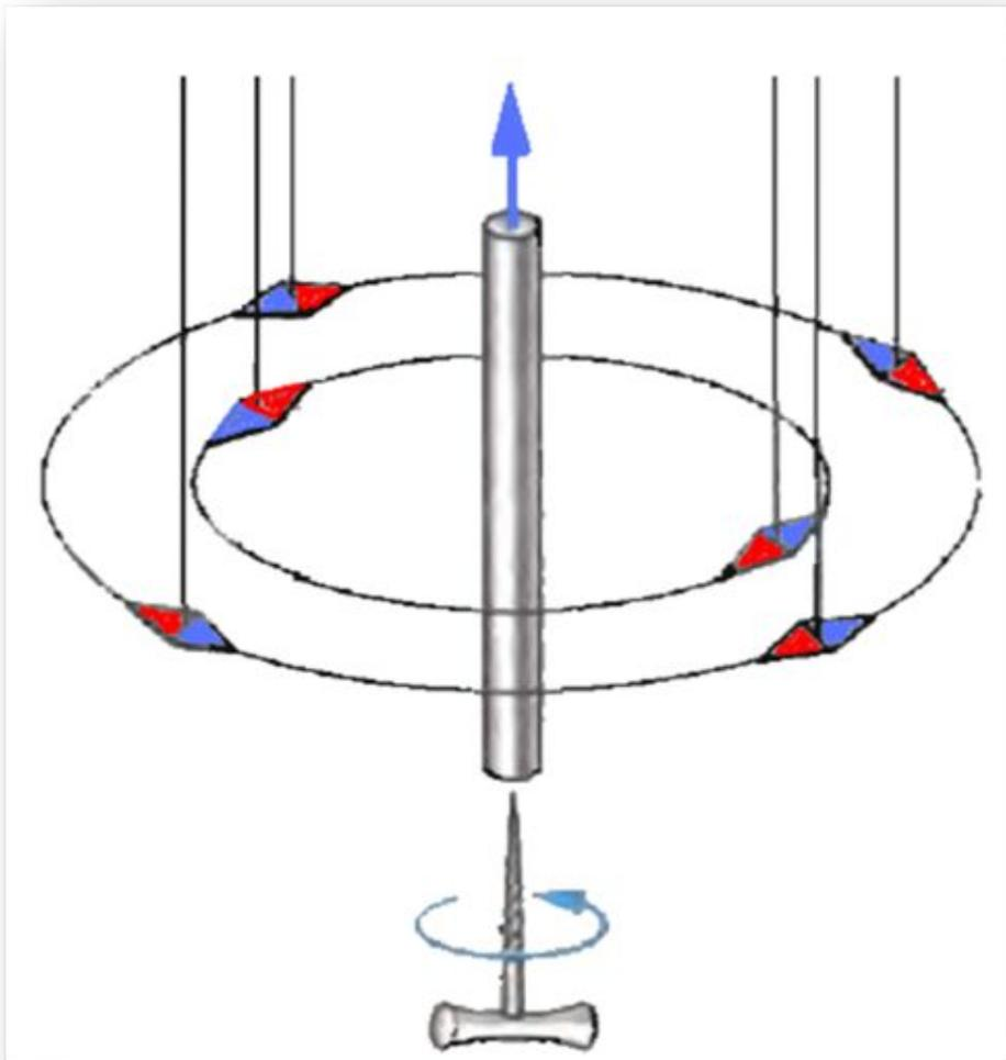
В магнитном поле прямолинейного проводника с током магнитная стрелка в каждой точке устанавливается **по касательной к окружности.**
