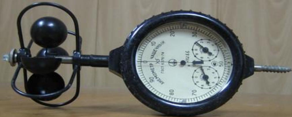
**Анемометр (от греческого анемос – ветер, и метрео – измерение) — измерительный прибор, предназначенный для определения скорости ветра, а также для измерения скорости направленных воздушных и газовых потоков.**
