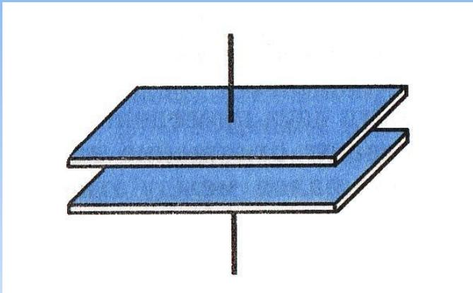
Простейший конденсатор состоит из двух плоскопараллельных пластин, находящихся на малом расстоянии друг от друга. Если заряды пластин одинаковы по модулю и противоположны по знаку, то силовые линии электрического поля начинаются на положительно заряженной обкладке
