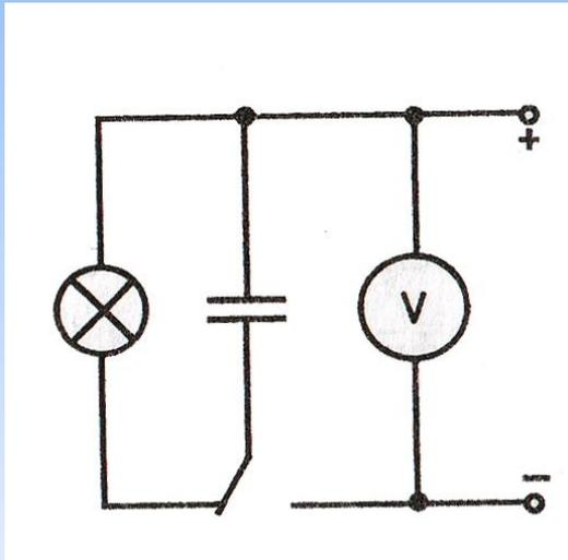
вспыхивает. Энергия конденсатора превращается в другие формы: *тепловую, световую*. Напряженность поля, созданного зарядом одной из пластин, равна  $E/2$ , где  $E$  – напряженность поля в конденсаторе. В однородном поле одной пластины находится заряд  $q$ , распределенный по поверхности другой пластины. Так как  $Ed=U$ , где  $U$  – разность потенциалов между обкладками конденсатора, то его энергия равна:
