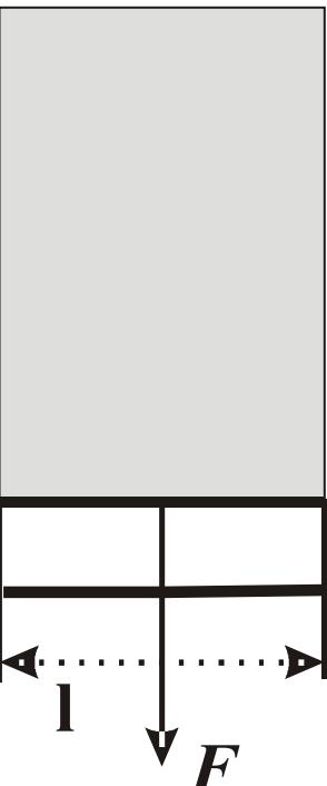
Рассмотрим рамку с невесомой подвижной перемычкой затянутую жидкой пленкой. Пленка имеет две поверхности (ту которую мы видим сверху и снизу под пленкой которая нам не видна). Чтобы перемычка не перемещалась, к ней надо приложить внешнюю силу  $F = 2l\sigma$ , уравновешивающую силу поверхностного натяжения 2-х поверхностей (в направлении  $\perp$  действию силы). Увеличив внешнюю силу, сместим перемычку на расстояние  $dx$ . При этом совершим работу:
