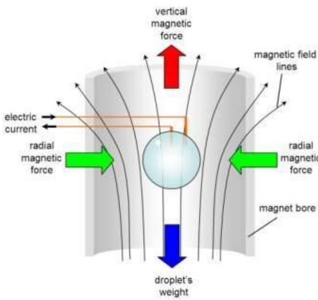
На Земле в поле силы тяжести диамагнитная капля воды левитирует в градиенте поля сверхпроводящего магнита (16.5 Тесла). С помощью электродов можно регулировать токи, которые врачают каплю. R. J. A. Hill and L. Eaves PRL, 101, 234501 (2008).
