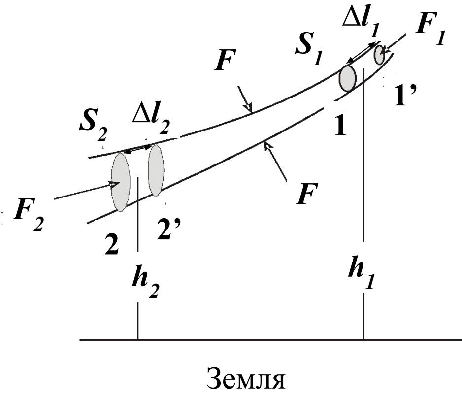
Рассмотрим **стационарное течение идеальной несжимаемой** жидкости в однородном силовом поле притяжения Земли. Пусть за  $\Delta t$  объем жидкости между нормальными сечениями  $1'$  и  $2'$  сместится вниз ( $p_1 > p_2$ ) по трубке тока до сечений  $1$  и  $2$  ( $\Delta l_1 \neq \Delta l_2$ ). Была совершена работа! На что израсходована? Какими силами?
