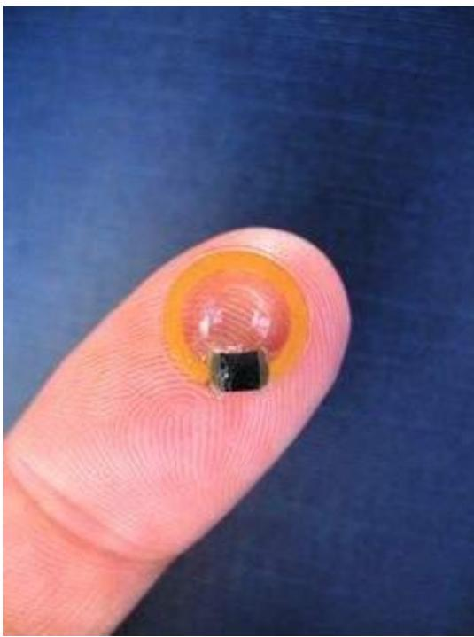
Внутриглазное давление скоро можно будет измерять с помощью современных датчиков, подобных показанному на рисунке. На краешке искусственной линзы разместился крохотный датчик размером 2.5 на 2.6 миллиметра, который измеряет внутриглазное давление.
