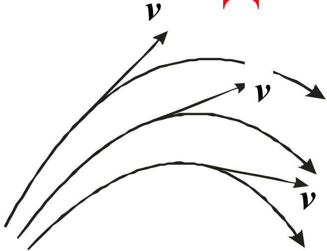
При изучение и описание движения жидкостей возможно два подхода. Первый- следить за отдельной частицами например красителя. Второй- следить не **за движением частиц самой жидкости, а за точками**
