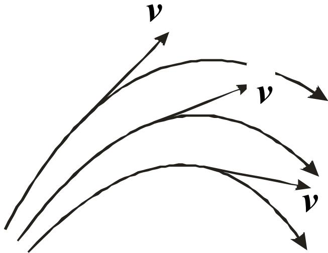
**Плотность линий** (как и в случае представления электрического и магнитного поля) **делают пропорциональной модулю** скорости в данном месте. Если скорость в каждой точке пространства остается постоянной,
