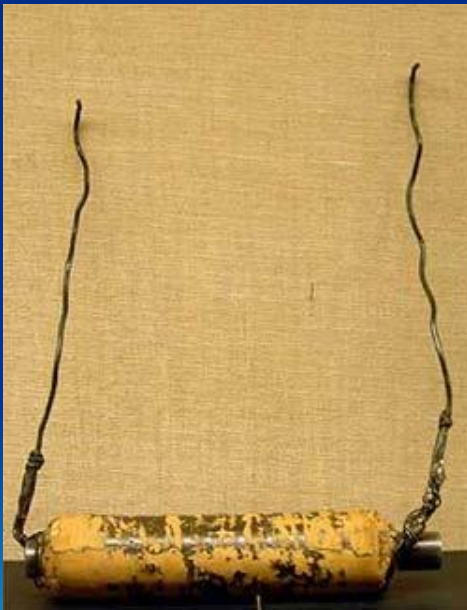
Первый униполярный генератор созданный Майклом Фарадеем.
