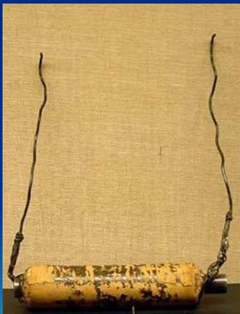
Первый униполярный генератор созданный Майклом Фарадеем.
