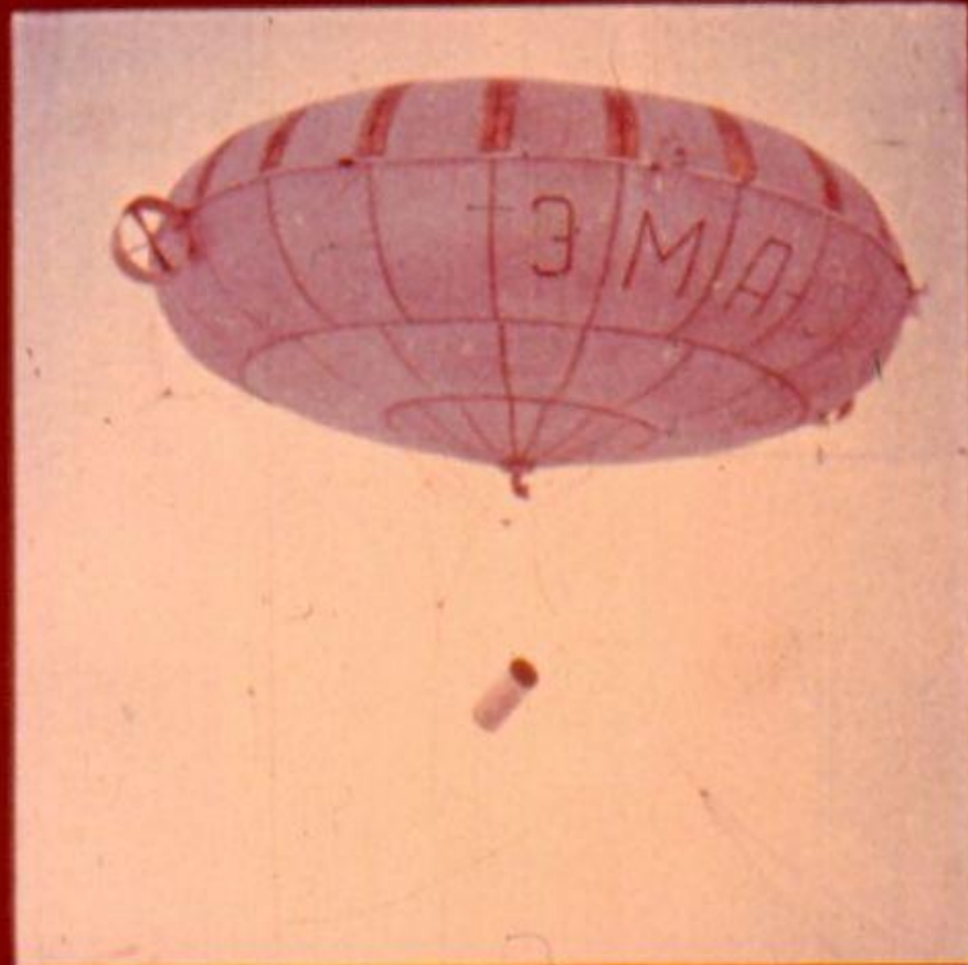
Испытание опытной модели воздушного подъемного крана.
