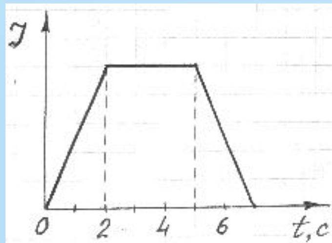
**(ЕГЭ 2002 г., Демо) А19.** В металлическое кольцо в течение первых двух секунд вдвигают магнит, в течение следующих двух секунд магнит оставляют неподвижным внутри кольца, в течение последующих двух секунд его вынимают из кольца. В какие промежутки времени в катушке течет ток?
