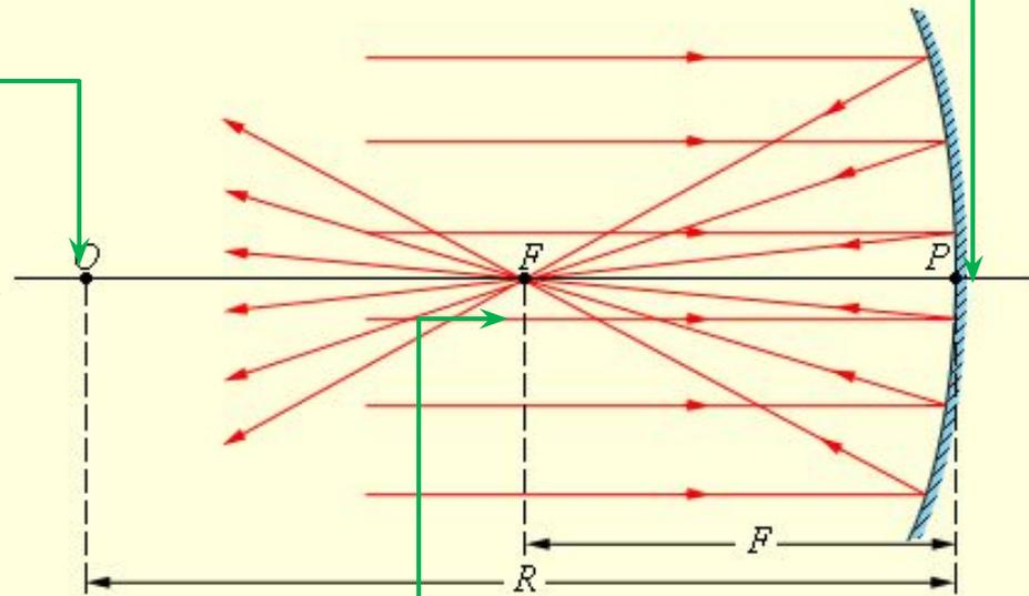
Если на вогнутое сферическое зеркало падает пучок лучей, параллельный главной оптической оси, то после отражения от зеркала лучи пересекутся в точке, которая называется **главным фокусом зеркала F**.
