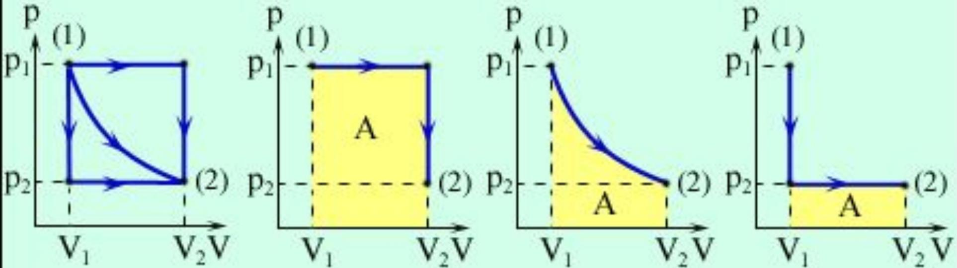
Три различных пути перехода из состояния (1) в состояние (2).
