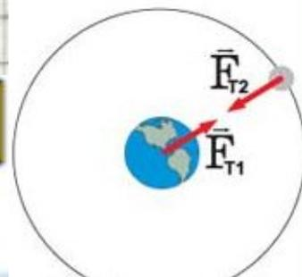
Всякое действие материальных точек (тел) друг на друга носит характер взаимодействия; силы, с которыми действуют друг на друга материальные точки, всегда равны по модулю, противоположно направлены и действуют вдоль прямой, соединяющей эти точки, где  $\vec{F}_{12}$  - сила, действующая на первую материальную точку со стороны, второй;
