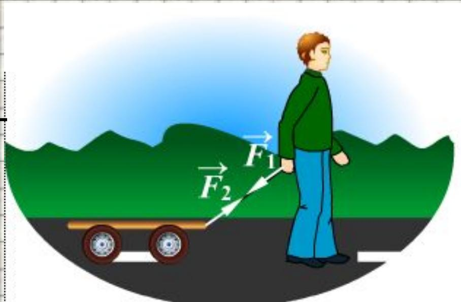
При этом **сила трения**, действующая на мальчика не должна превышать силу трения, действующую на тележку.
