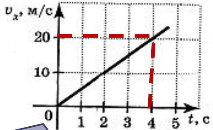
$$a = \frac{(20 - 0) \frac{\text{м}}{\text{с}}}{4 \text{ с}} = 5 \frac{\text{м}}{\text{с}^2}$$
