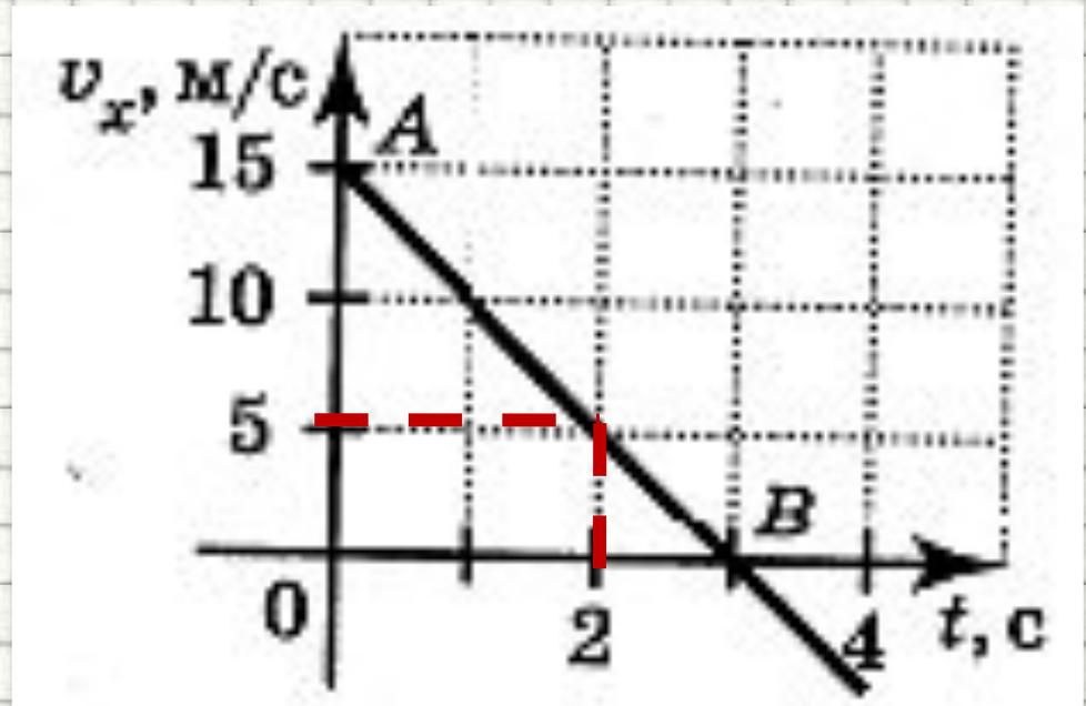
**ГИА-2010-1.** На рисунке представлен график зависимости проекции скорости грузовика на ось  $x$  от времени. Проекция ускорения грузовика на эту ось в момент  $t=3$  с равна
