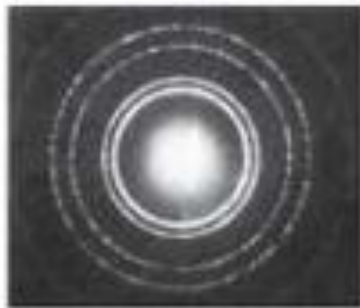
Результат дифракции рентгеновского излучения (вверху) и пучка электронов (внизу) на кристаллической решетке алюминия
