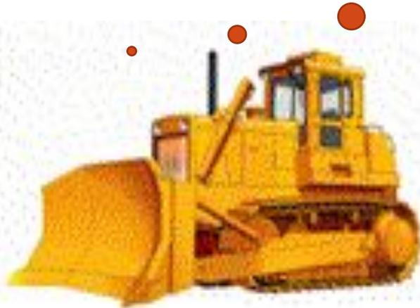
... давление гусеничного трактора массой 6,7 тонны на почву составляет **47 000 Па.**
