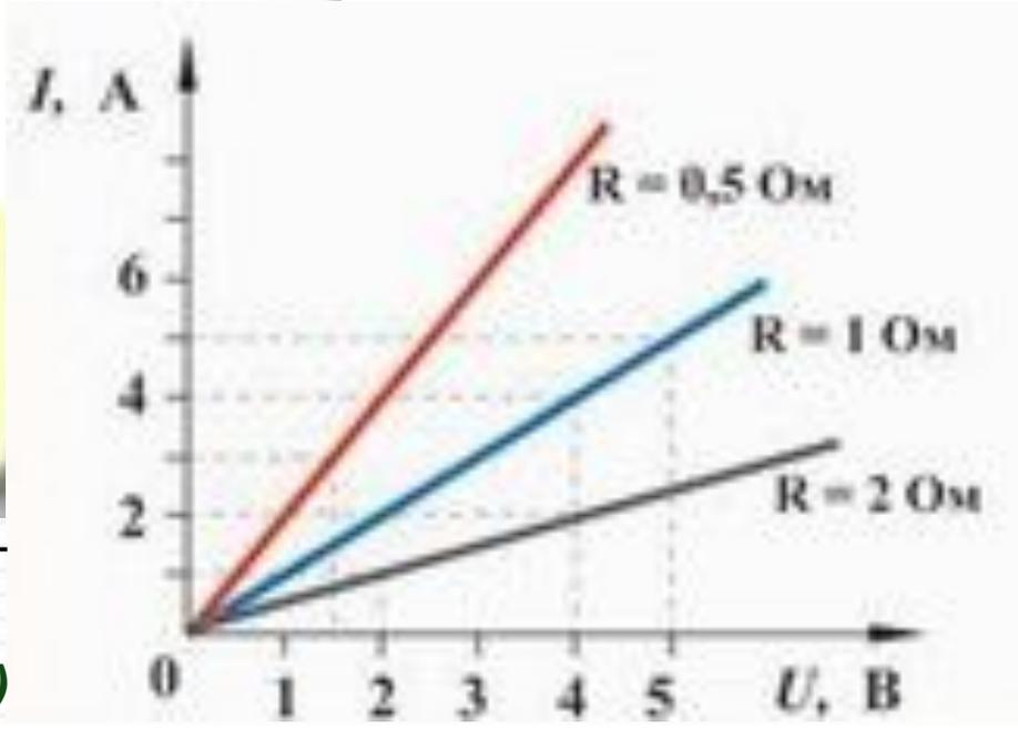
Графическая зависимость силы тока  $I$  от напряжения  $U$  (такие графики называются **вольт-амперными характеристиками**)
