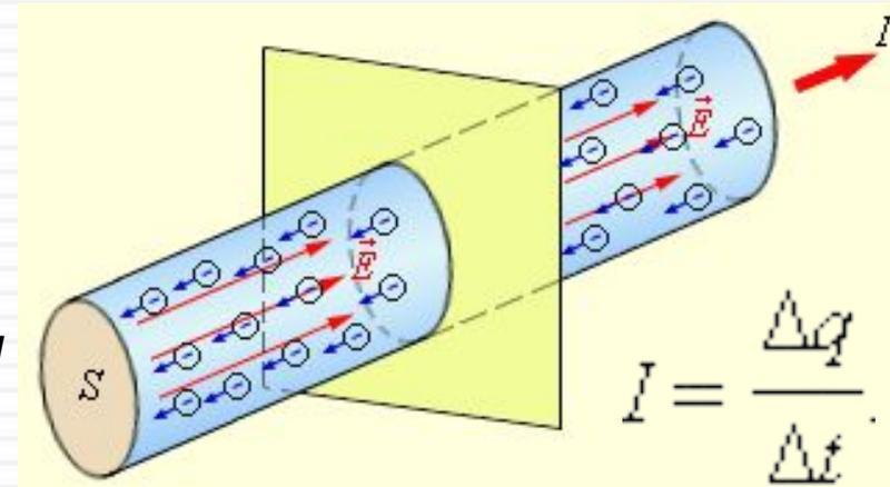
$S$  – площадь поперечного сечения проводника,
