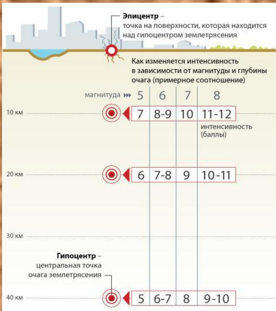
Интенсивность характеризует степень сотрясения земной поверхности. Она измеряется по 12-балльной шкале
