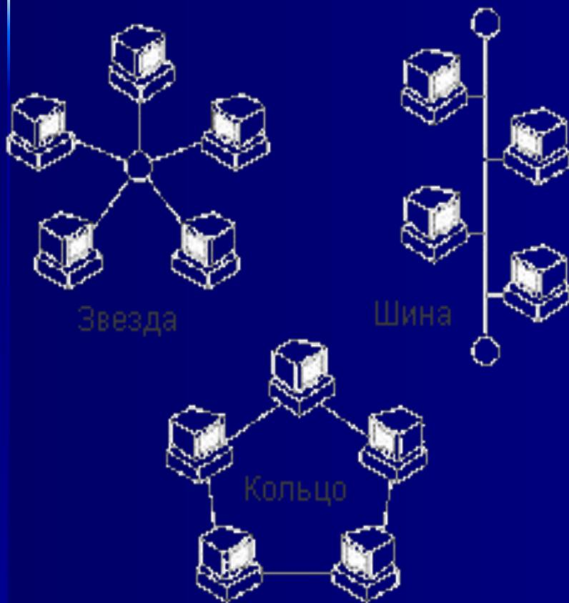
Имеется три принципиальных топологии, используемых в локальных вычислительных сетях: **шина**, **звезда**, **кольцо**
